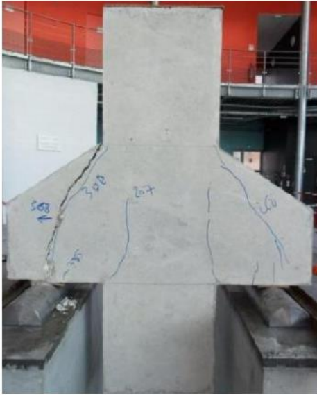
a) C0 : Flexion failure
